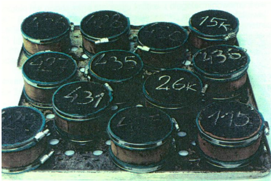
Fot. 20 – Widok próbek walcowych przygotowanych do starzenia długoterminowego
