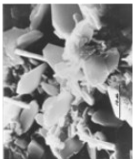
Fot. 8 – Kryształy zeolitu w powiększeniu [9]
