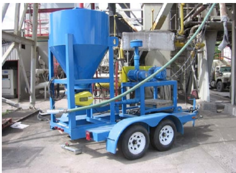
Fot. 11 – Przewoźny silos zeolitu współpracujący z otaczarnią o działaniu ciągłym [11]
