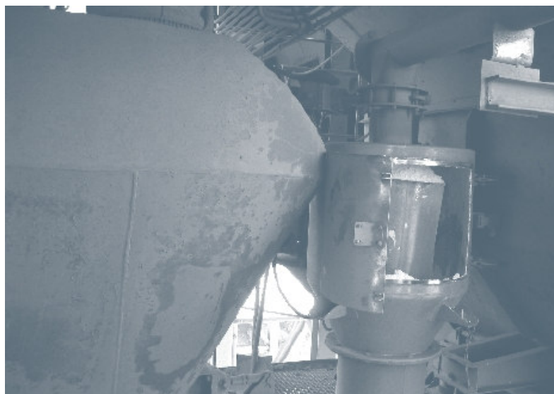
Fot. 10 – Zasobnik wagowy służący do odmierzania ilości zeolitu [3]
