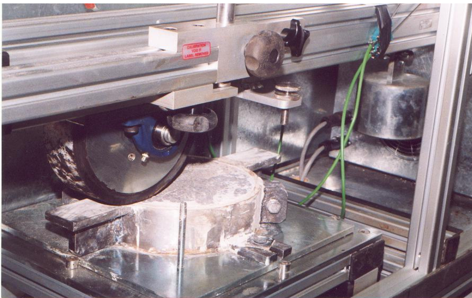
Fot. 22 – Widok próbki podczas badania koleinowania (w pracy badano próbki prostopadłościowe, inne niż fotografii)
