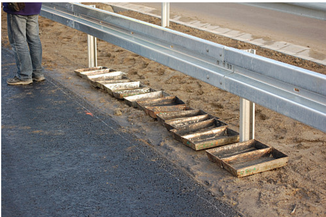
Fot. 27 – Przygotowane do pobrania próbek mieszanki foremki stalowe
