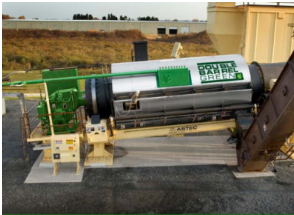
Fot. 15 – Ogólny widok bębna suszarki wytwórni Astec Double Barrel Green. W centrum widoczny jest zespół dysz do wtryskiwania wody i asfaltu [12]
