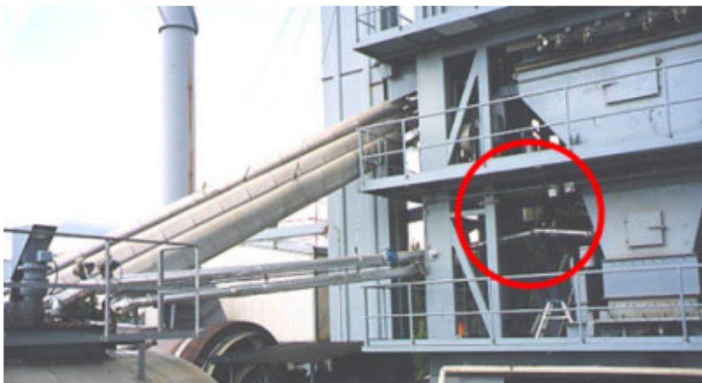
Fot. 13 – Otaczarnia o działaniu cyklicznym z instalacją WAM-Foam. Widoczne dwie linie doprowadzenia asfaltu. Czerwonym okręgiem zaznaczono położenie komory spieniania [9]
