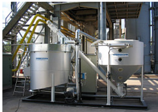
Fot. 3 – Dozator przeznaczony do współpracy z wytwórnią o działaniu cyklicznym. Widoczne dwa zbiorniki – jeden do przechowania granulek, drugi do ich podgrzewania [17]
