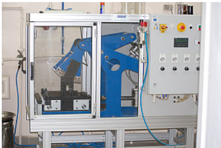
Fot. 21 – Zagęszczarka walcowa wykorzystana do wykonania próbek do koleinowania (na zdjęciu brak formy)
