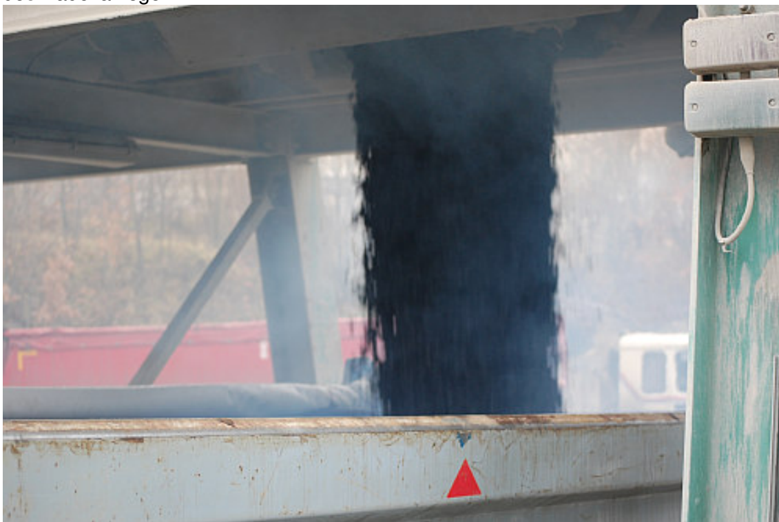
Fot. 24 – Pierwszy załadunek samochodu ciężarowego mieszanką SMA wyprodukowaną ze środkiem Ceca Base RT
