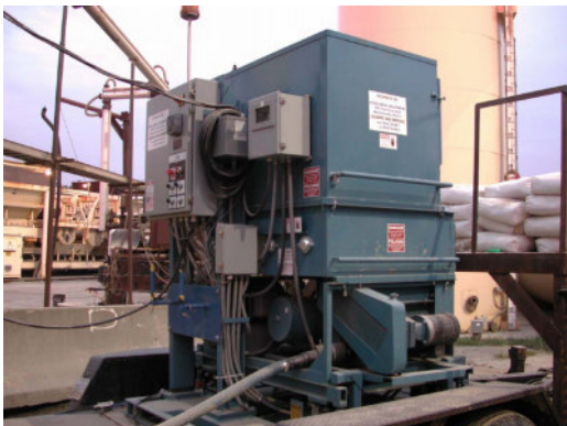
Fot. 2 – Pneumatyczny dozator Sasobitu. W dolnej części widoczny ciśnieniowy przewód transportujący granulki [9]
