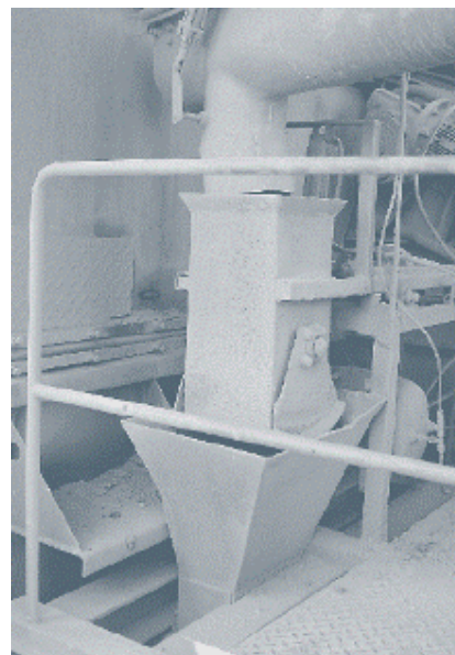
Fot. 5 – Zasobnik wagowy służący do odmierzania niezbędnej ilości środka – wytwórnia mas bitumicznych w Niemczech [3]
