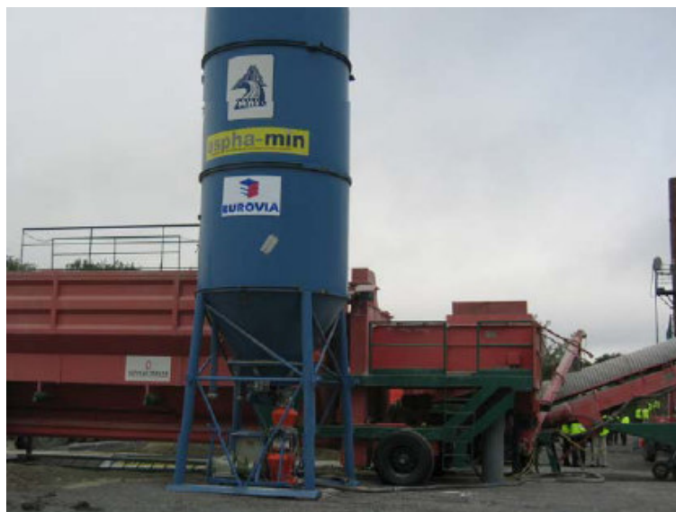
Fot. 12 – Stały silos przeznaczony do magazynowania zeolitu. U podstawy silosa widoczny jest mechanizm transportujący drogą pneumatyczną zeolit do otaczarni [11]
